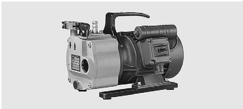
S 1.5 属于单级、带气镇的油封旋片泵。它由法兰安装的交流电机驱动。泵轴和电机轴采用销联轴节相连。
