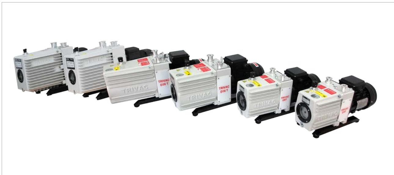
TRIVAC T是新型双级油封式旋片真空泵，结构紧凑坚固，莱宝真空全新开发抽速为4m<sup>3</sup>/h-60m<sup>3</sup>/h抽速的真空泵，TRIVAC T全系列真空泵及其各种附件特别为广泛的工业应用而设计。产品适用性强，新型防返油设计，双重保护，内部泵体采用无密封元件的组装，便于拆卸和重新装配，维修方便。D4T到D30T型号的所有泵还都配备了单相或三相电机。
