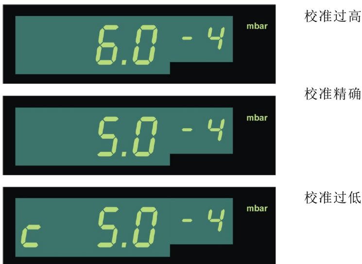
图 17 - THERMOVAC 传感器的零点调整
