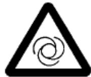
只有在电源电压切断且泵不再转动之后（绿色 LED 熄灭）才能拔下接插件插头。
