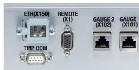
接口齐全，连接显示两个真空计
